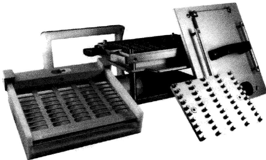
Diponibile nel modello per la preparazione di 100 capsule (**MiniKUBICAP 10.10**) e per la preparazione di 300 capsule (**KUBICAP 30.10**), l'opercolatrice viene fornita di serie per un formato a scelta del cliente, con i seguenti accessori:
