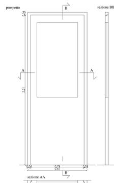
SERRAMENTO TIPO IB NB: Serramento talvolta dotato anche di sopralluce vetrato
