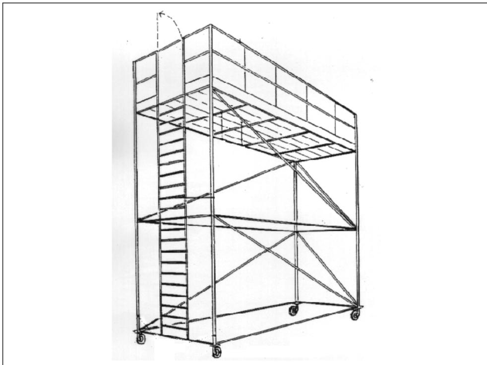
La loro base deve essere sufficientemente ampia per resistere oltre ai carichi anche alle oscillazioni a cui essi saranno inevitabilmente sottoposti durante gli spostamenti ed alle
