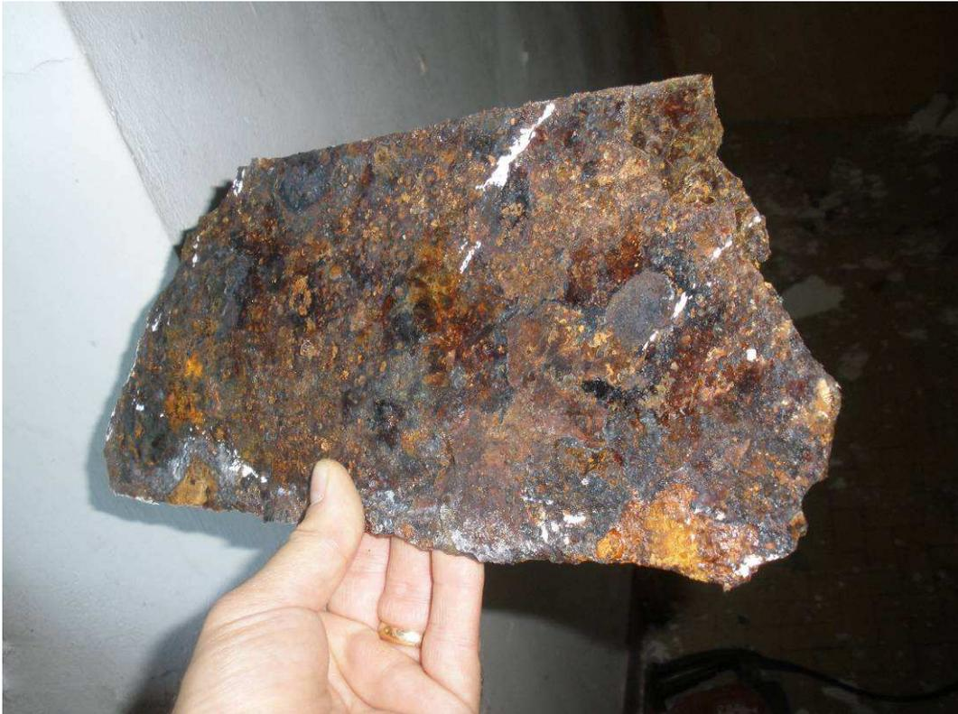
**Figura 4-6 elemento distaccato dall'ala inferiore della putrella di copertura**
