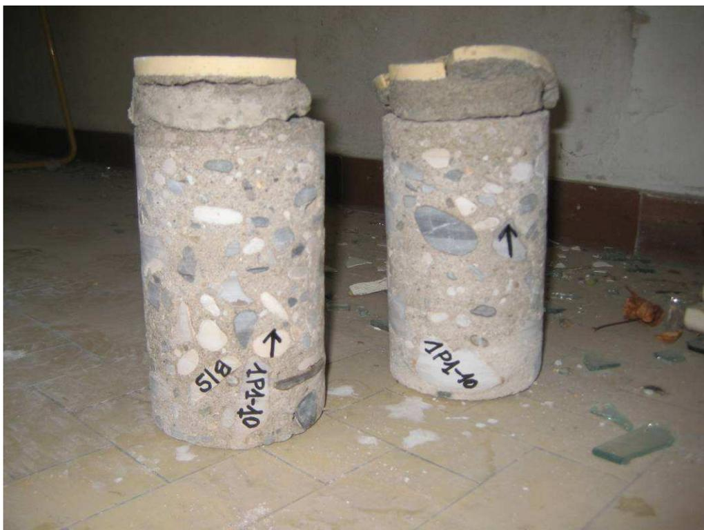
Figura 2-118 Esito del carotaggio eseguito sul solaio del piano primo nel corridoio.
