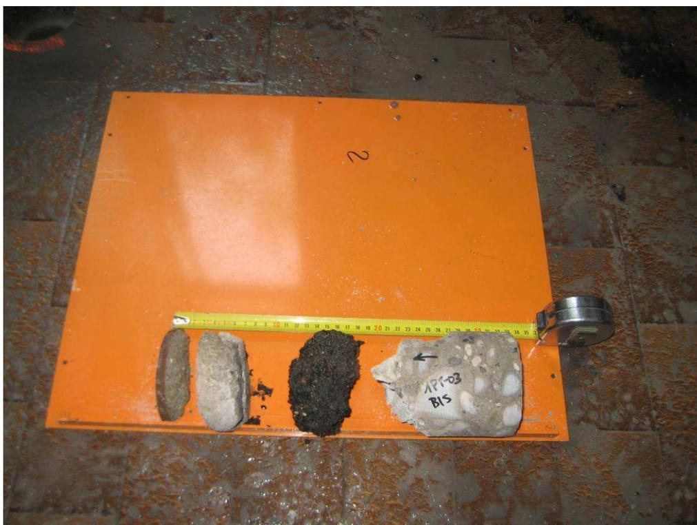
**Figura 2-121 Esito del carotaggio sul solaio Matrai tipo 1 del piano terra.**
