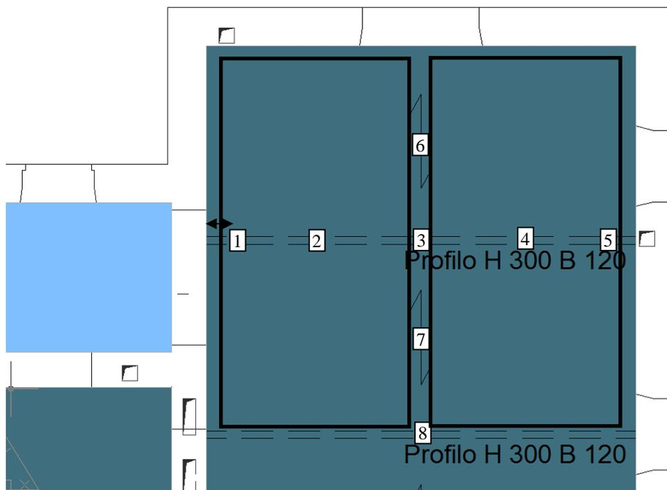
**Figura 3-6** Posizione dei sensori per la misurazione degli abbassamenti e delle aree caricate
