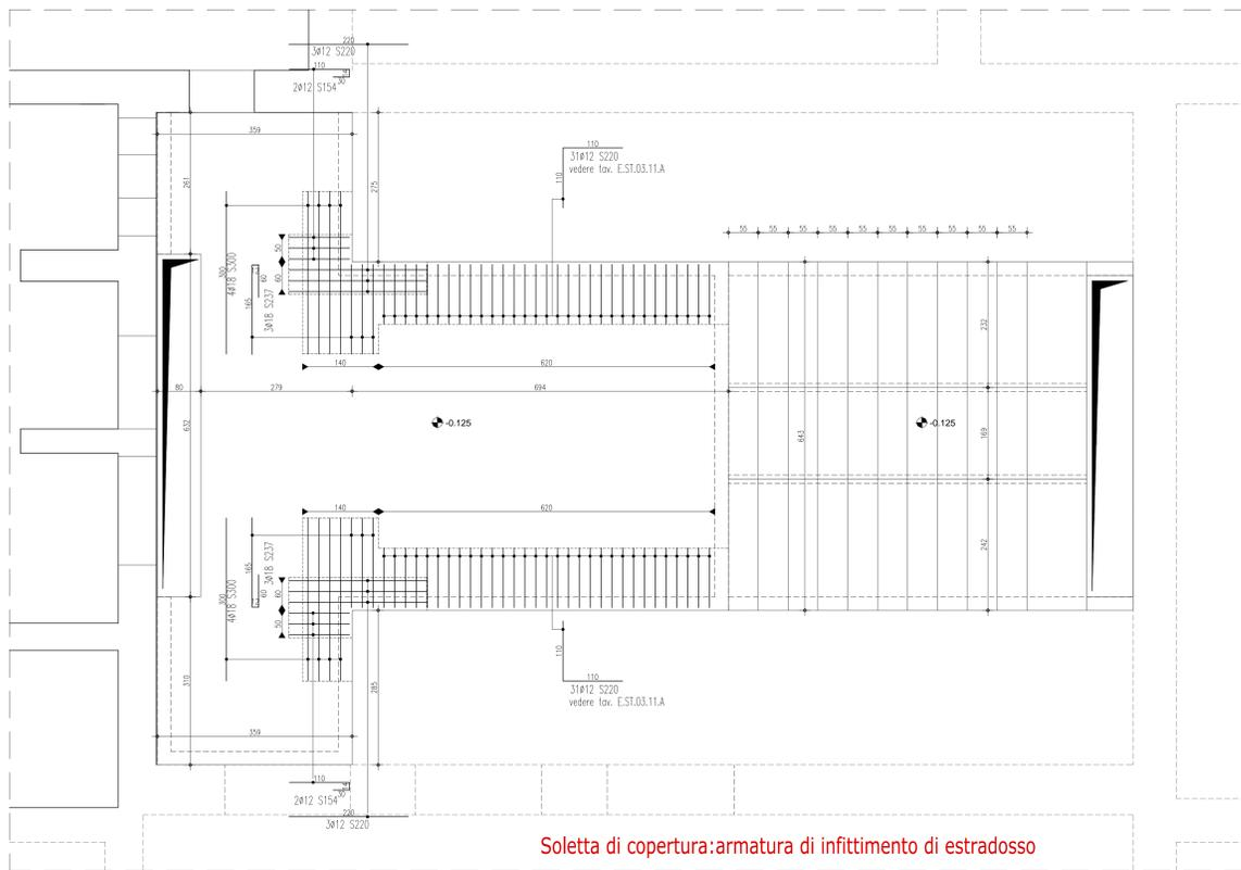
Soletta di copertura: armatura di infittimento di estradosso
